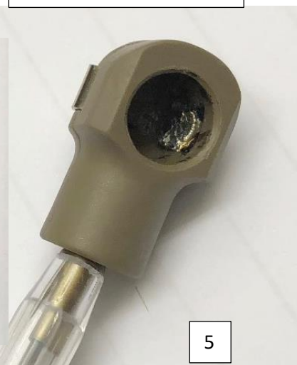
Bild 3: Defekt bleck på huva. Bleckets små "armar" syns inte.
