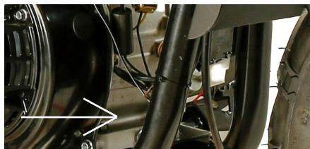
Motornumret är stansat på oljebehållaren på motorns framsida.
